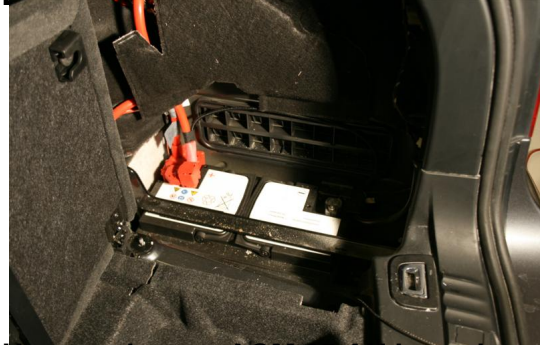
Her ses det nye AGM 80 AH batteri og det er super vigtigt at man får kodet det til bilen.
