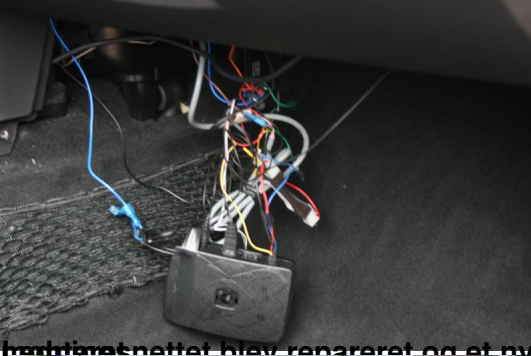
håndfri nettet blev repareret og et nyt håndfri som kører over bilens originale Most system blev
